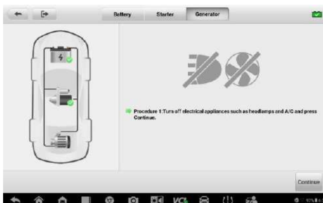
Рисунок 9-11. Пример окна проверки генератора переменного тока
